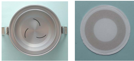
図1 スリット型ジェットノズル(左)とフィルタ捕集面(右)
